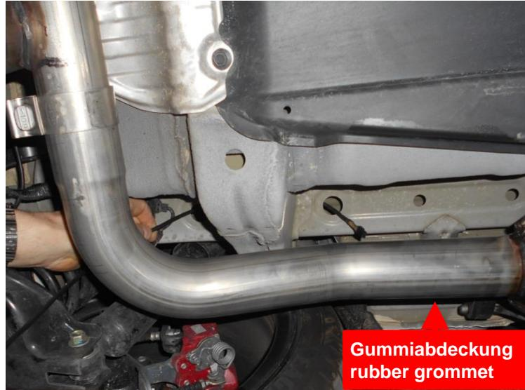
Die Gummiabdeckung entfernen und das Aktuatkabel durch die Öffnung in das Staufach des Pannensets führen.
