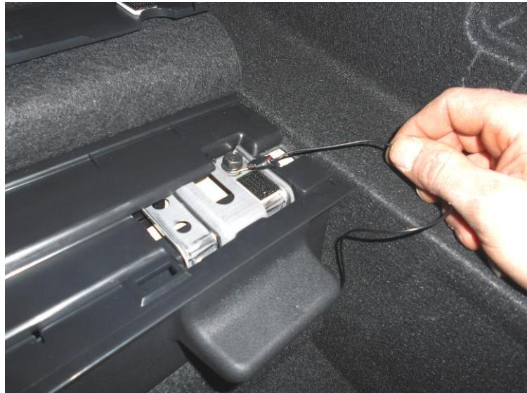
Die REMUS Steuereinheit mit dem Aktuator- und Zuleitungskabel verbinden. Die Steuereinheit in der Öffnung verstauen und mit den mitgelieferten Kabelbindern fixieren.
