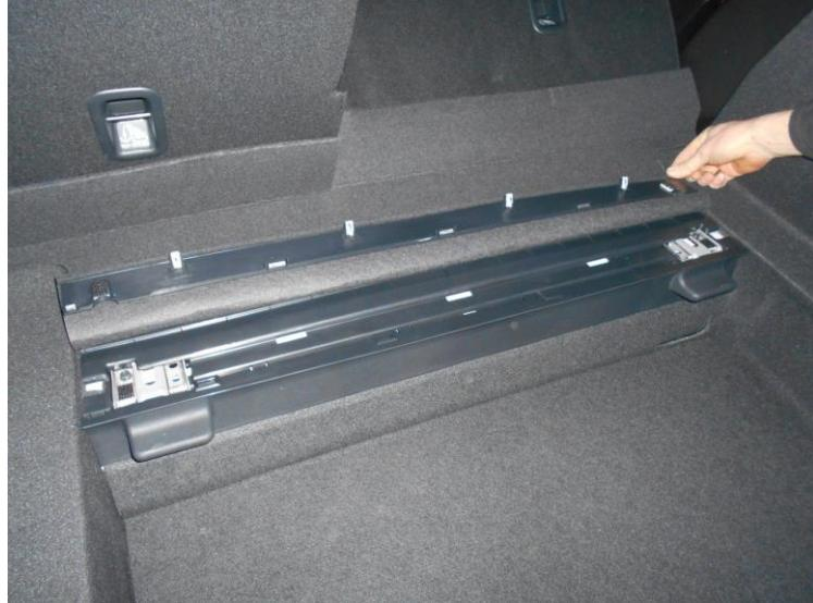
Das schwarze Kabel des Zuleitungskabels unter der Verkleidung bis zur hochgeklappten Abdeckung verlegen.
