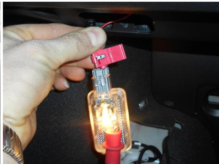
Das schwarze Kabel des Zuleitungskabel unter der Verkleidung verlegen.
